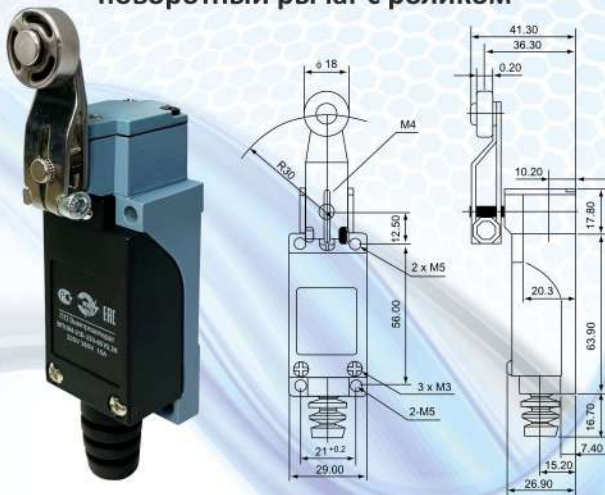
ВП19М21Б233-65 У2.28 поворотный рычаг с роликом
