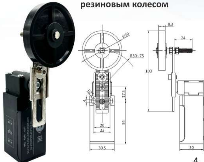
ВП19М21Б392-65У2.11(12,14).33А поворотный регулируемый рычаг с регулируемым по выносу резиновым колесом
