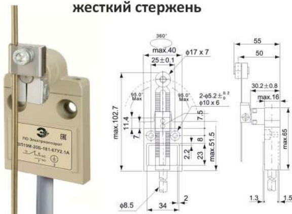
ВП19М20Б181-67У2.1А, поворотный регулируемый жесткий стержень
